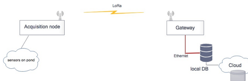
Figure 3: Architecture de la station de mesure. Extrait de [15]
